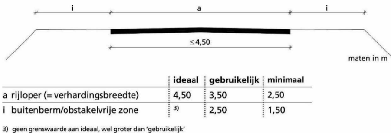
Figuur 3.6: Standaard dwarsprofiel erftoegangsweg type 2
