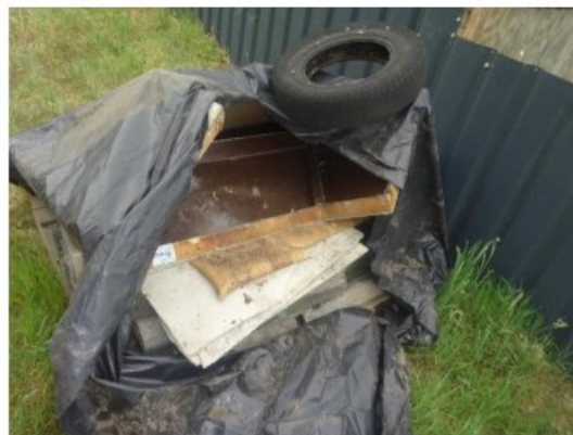
Monsternamelocatie MA09 (asbest aantoonbaar)
