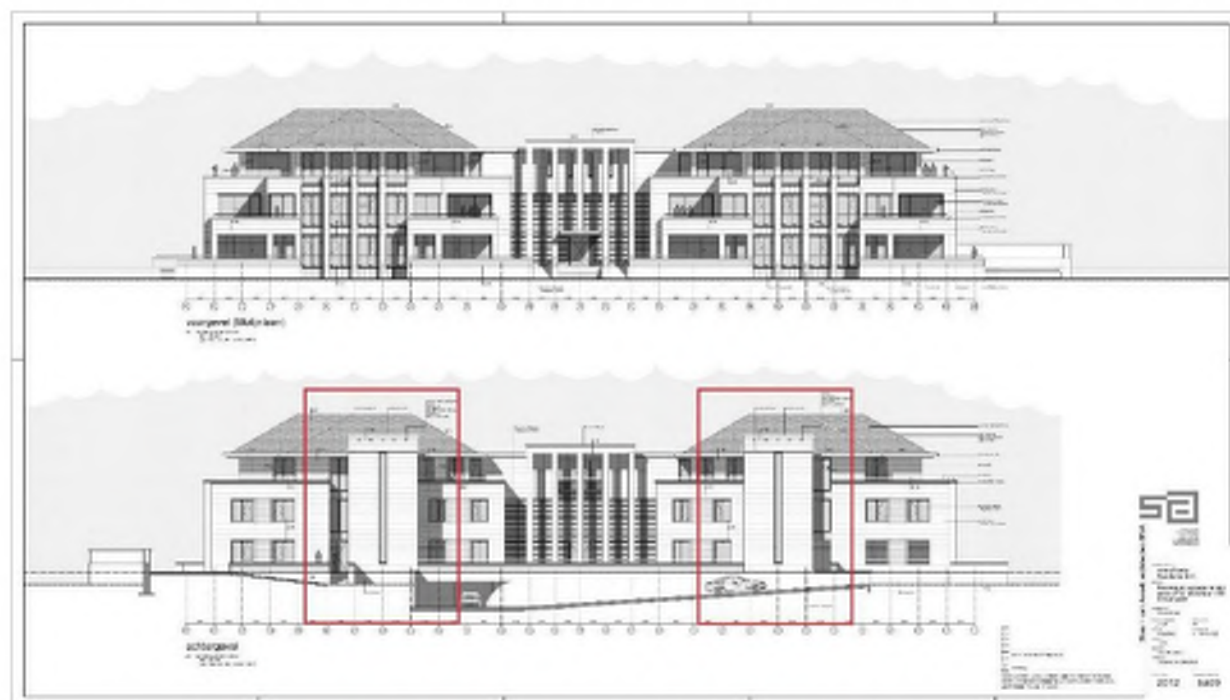
Afbeelding 8. Locaties permanente voorzieningen trappenhuizen F.A. Molijnlaan 166.
