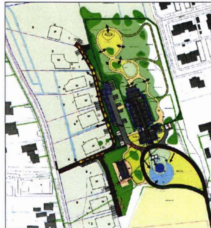
Figuur 1 Voorstel uitwerking watersysteem, de blauw gearceerde delen in het westen zijn de voorgestelde locaties met waterbergende wegfundering
