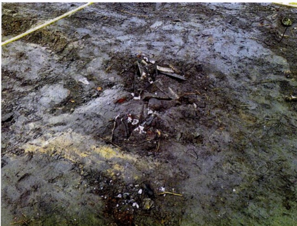
Foto 1: aangetroffen spot met asbesthoudend afval
