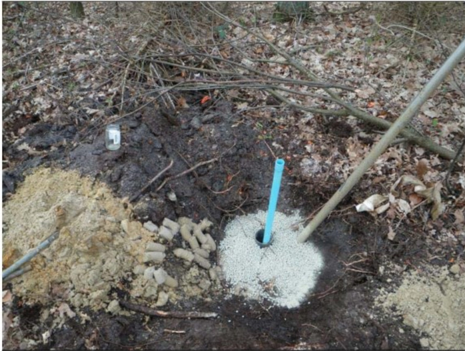
Foto b2.5 Peilbuis 101 met verloren casing
